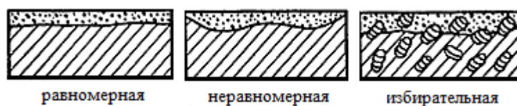
Рисунок 1. Виды общей коррозии
