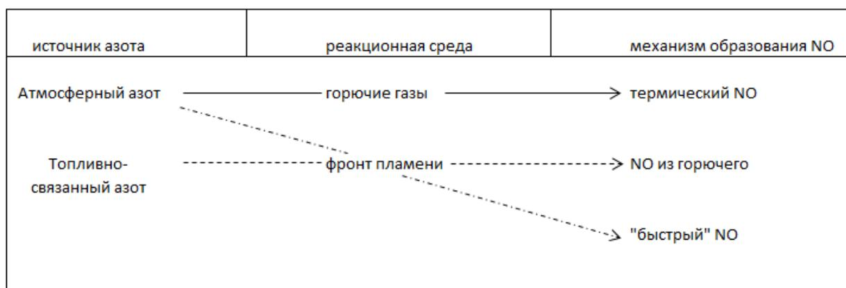
Рисунок 1. Схематичное изображение механизмов образования оксидов азота
