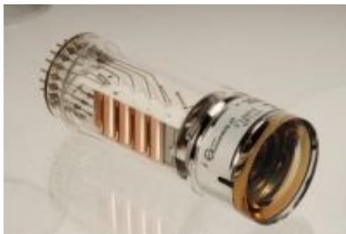
Рис. 5.2. Внешний вид фотоэлектронного умножителя
