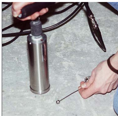
Рис. 7.4. Возбуждение колебаний механическим ударом
