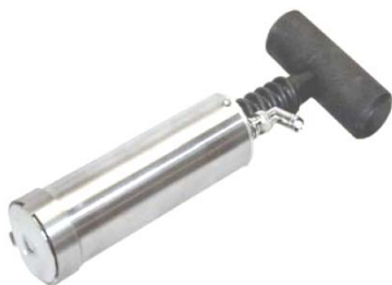
Рис. 7.5. Приемные акустические преобразователи: a – цилиндрический – для выявления неоднородностей и оценки упруго-прочностных характеристик бетона; б – двоянный – для оценки скорости акустической волны ( http://www.impact-echo.com )
