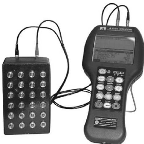
Рис. 7.26. Низкочастотный дефектоскоп А1220-МОНОЛИТ ( http://www.acsys.ru )
