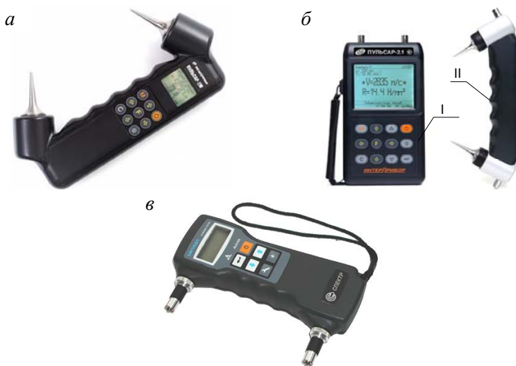
Рис. 7.22. Ультразвуковые приборы контроля бетона: а, б – приборы серии «Пульсар»; в – УК1401
