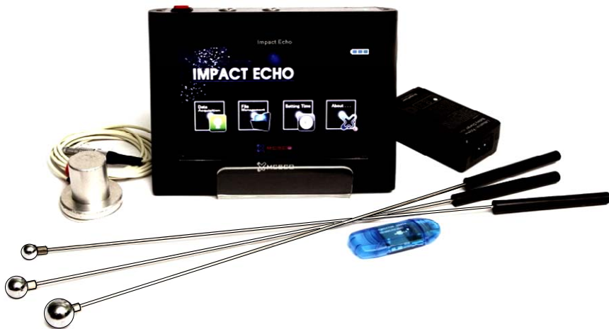
Рис. 7.3. Типичный комплект системы для оценки состояния бетонных изделий Impact-Echo методом ( http://www.impact-echo.com )
