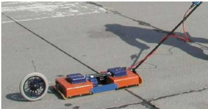
Рис. 7.29. Антенный блок АБ-400 георадара «ОКО» при обследовании плит взлетно-посадочной полосы ( http://www.logsys.ru )
