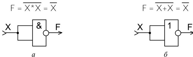
Рисунок 2.8 – Преобразования функции НЕ к базовому элементу И-НЕ (*a*) и базовому элементу ИЛИ-НЕ (*б*)
