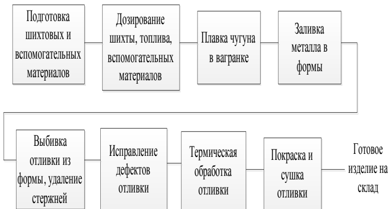
Рисунок – Принципиальная схема производства чугунных отливок
