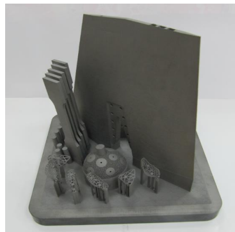
Рисунок 5 – Экспериментальные образцы деталей после 3D-печати
