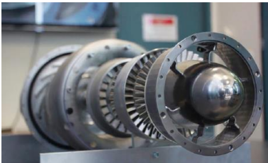
Рисунок 1 – Элементы авиационного двигателя, изготовленные методом СЛП
