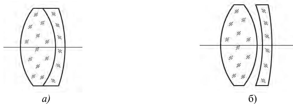
Рис. 10.1: а) двухлинзовый склеенный; б) двухлинзовый несклеенный объектив
