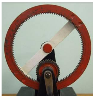
Рис. 1. Вид и схема цилиндрических зубчатых передач a – с внешним зацеплением, б – с внутренним зацеплением
