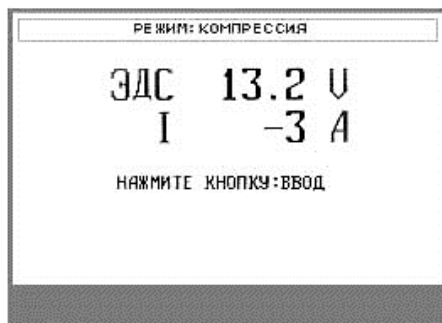
Рис. 2.3. Окно выполнения команды мотор-тестера
