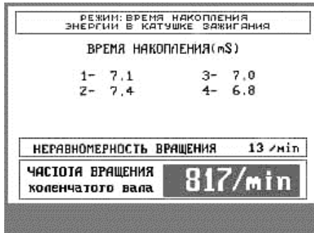
Рис. 3.2. Окно сообщения результатов измерения времени накопления энергии в катушке зажигания
