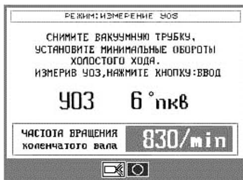
Рис. 5.1. Окно сообщения результатов измерения угла опережения зажигания
