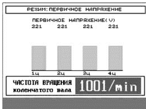
Рис. 4.2. Гистограммы первичного напряжения на катушке зажигания
