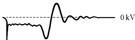
Рис. 4.27. Осциллограмма вторичного напряжения с неисправностями
