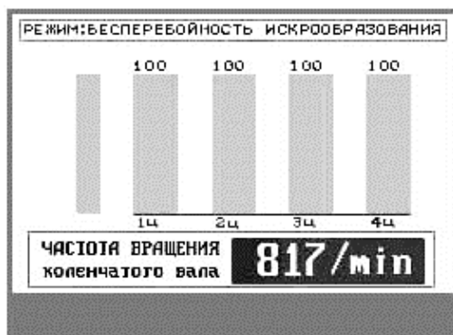
Рис. 4.11. Гистограммы бесперебойности искрообразования по цилиндрам
