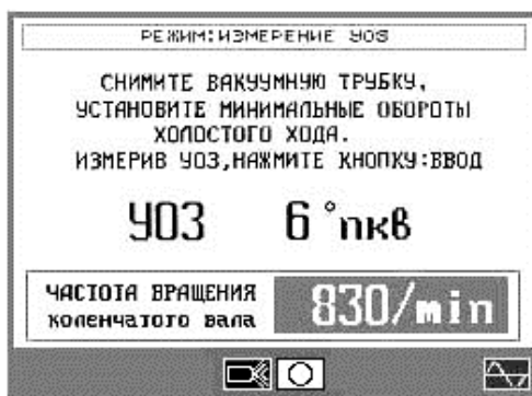
Рис. 5.5. Окно сообщения результатов измерения угла опережения зажигания
