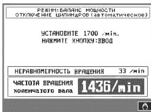
Рис. 6.4. Окно выполнения команды мотор-тестера
