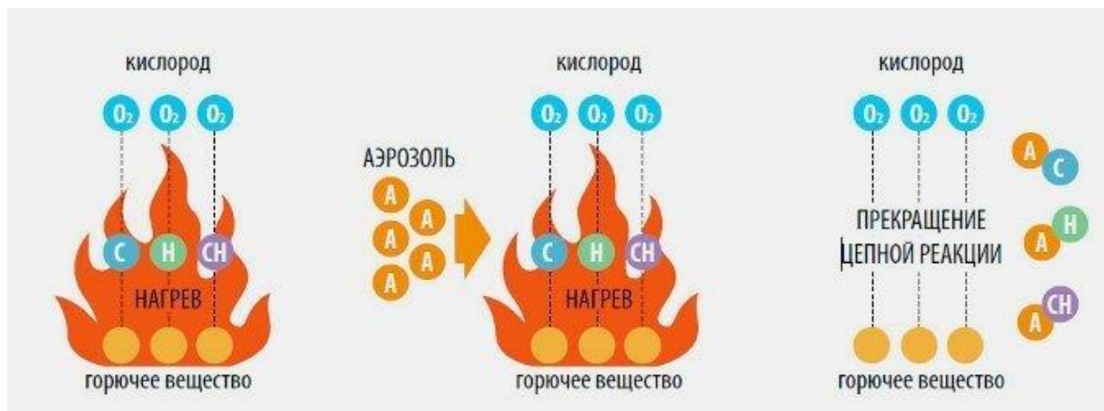
Рисунок 3 – Принцип работы аэрозольной системы пожаротушения
