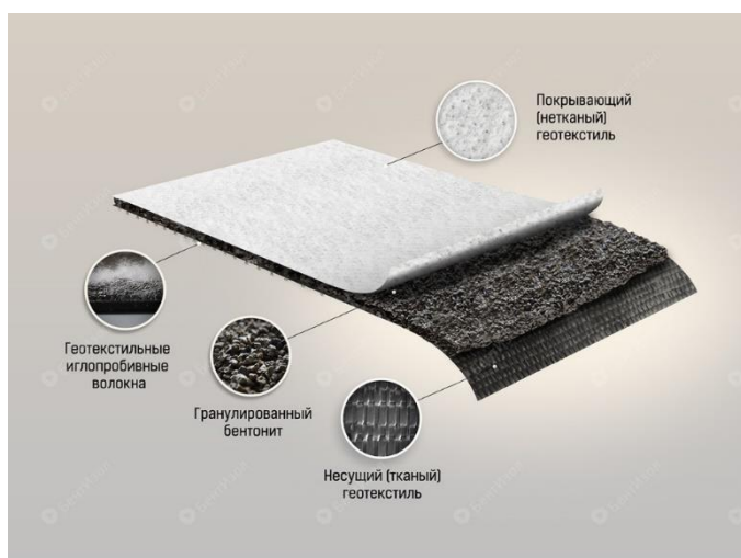
Рисунок 1 – Структура бентонитового мата
