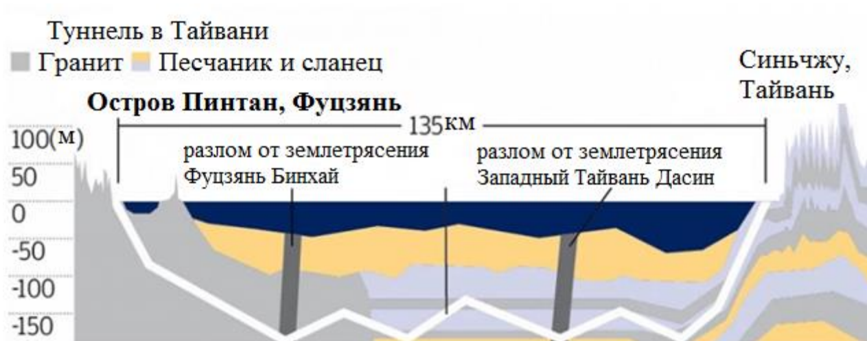
Рисунок 10 – Продольный профиль туннеля
