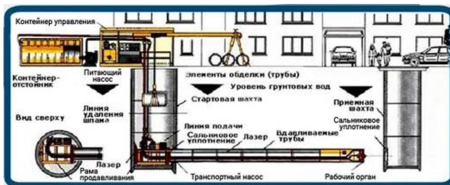
Рисунок 1 – Принципиальная схема микротоннелирования
