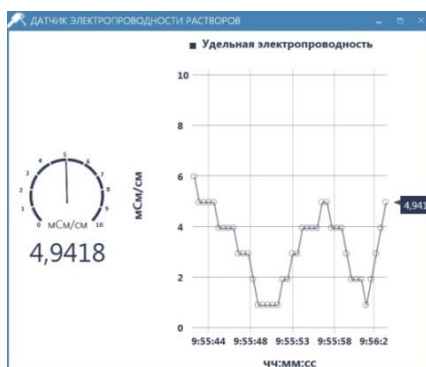
Рисунок 3 – Информационное окно ПК в режиме измерения электропроводности
