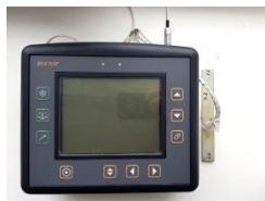
Рисунок 2 – Фотография внешнего вида вихретокового дефектоскопа «Вектор» в комплекте с экспериментальным образцом исследуемого меандрового вихретокового преобразователя
