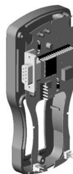
Рисунок 5 – Твёрдотельная модель блока управления устройства позиционирования
