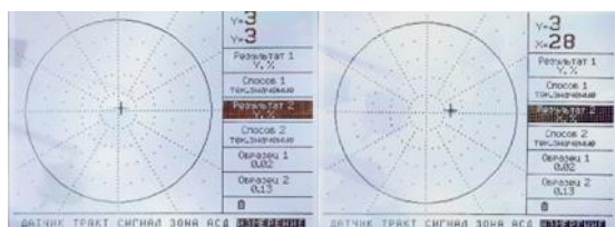
Рисунок 4 – Пример изображения (фото) годографов МВП с экрана дефектоскопа:
