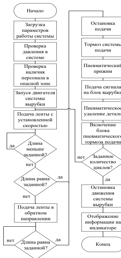
Рисунок 3 – Алгоритм работы автоматизированной линии станка производства профилей
