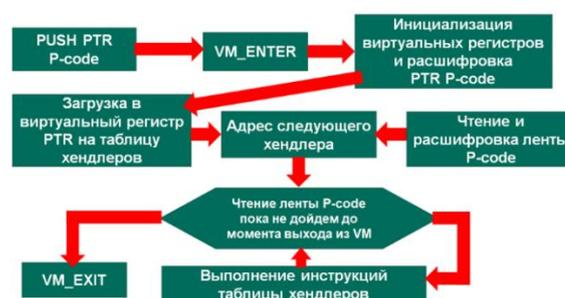
Рисунок 1 – Структура виртуальной машины
