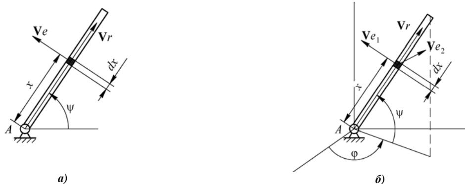
Рисунок 1. – Кинематика стержня, участвующего во вращательном (а) и сферическом (б) движении
