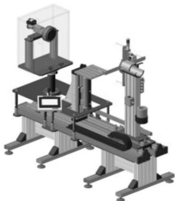
Рисунок 1 – Общий вид стенда С-1 с установленной экстраполяционной ионизационной камерой МЭК-1
