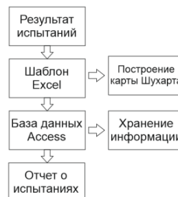
Рисунок 4 – Принцип взаимодействия программных компонентов
