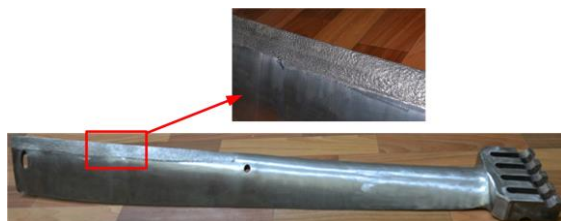
Рисунок 4 – Внешний вид лопатки паровой турбины с ЭИЛ покрытием на рабочей кромке
