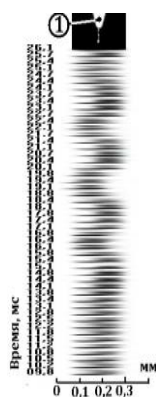
Рисунок 3 – Кинемограмма процесса нежелательных колебаний рабочего торца сварного микроинструмента (поз. 1) во время срабатывания электромагнитного механизма зажима микропроволоки
