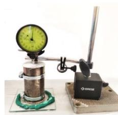
Рисунок 2 – Фотография общего вида лабораторной установки для определения объемного расширения стоматологического гипса
