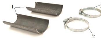
Рисунок 3 – Фотография полуцилиндров 1 и зажимных хомутов 2
