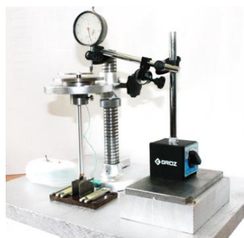
Рисунок 6 – Фотография общего вида устройства определения упругих свойств инъекционных игл при их установке на две опоры
