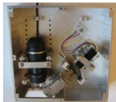
Рисунок 4 – Фотография оптического блока профилометрического устройства со снятой крышкой
