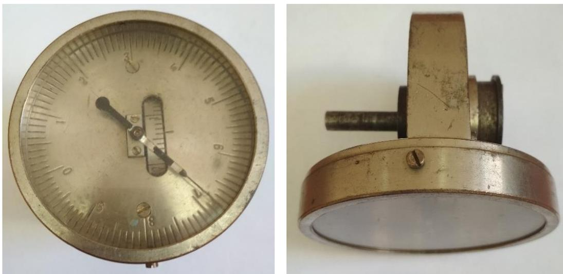
Рисунок 12 – Общий вид прогибомера Максимова
