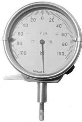
Рисунок 7 – Индикаторная головка (ИГ)
