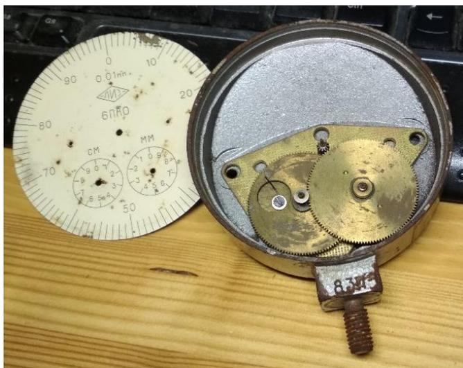
Рисунок 10 – Внутренне устройство прогибомера Аистова
