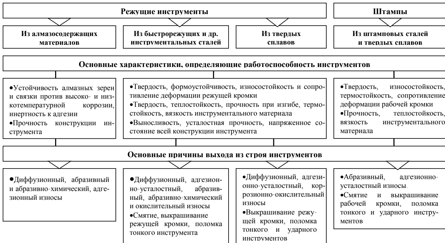
Рис. 8.1. – Эксплуатационные требования и причины выхода из строя металлообрабатывающих инструментов
