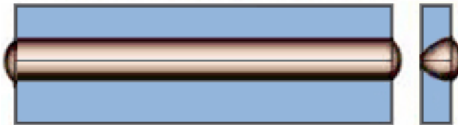
Рис. 12. Сплошной сварной шов
