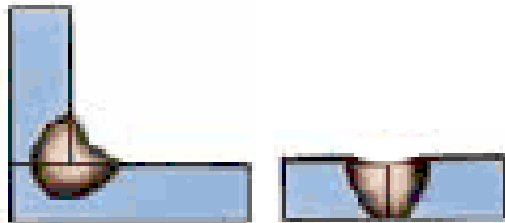
Рис. 21 Вогнутый сварной шов
