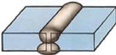
Рис. 6. Стыковое сварное соединение
