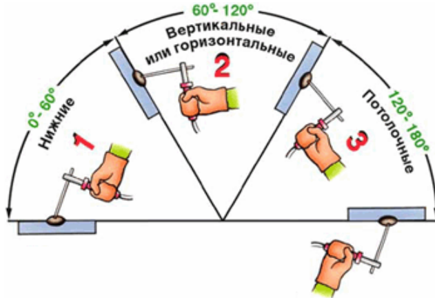
Рис. 11. Классификация по положению в пространстве: 1 – нижнее положение; 2 – горизонтальное или вертикальное положения; 3 – потолочное положение
