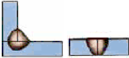
Рис. 19 Нормальный сварной шов
