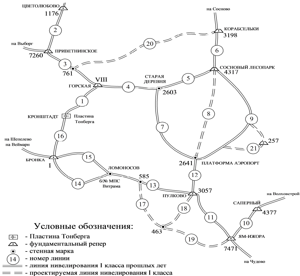
Рис. 1. Схема существующей сети и проектируемых линий нивелирования I класса
