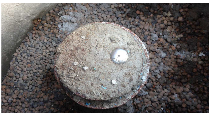
Рис. 5. Новый заложенный фундаментальный репер
