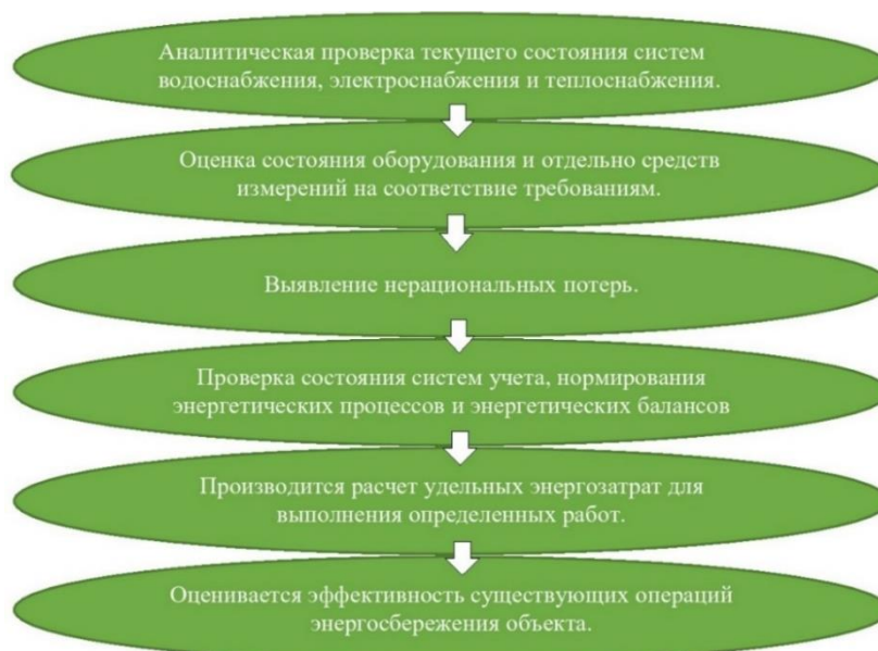
Рисунок 1 Действия, которые проводят при энергетическом обследовании.
