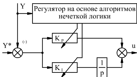
Рисунок 6 – Структура регулятора скорости на основе алгоритмов нечеткой логики
