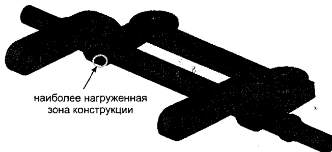
Рис. 3. Конечно-элементная модель оси прицепа со штампованными ее опорами
