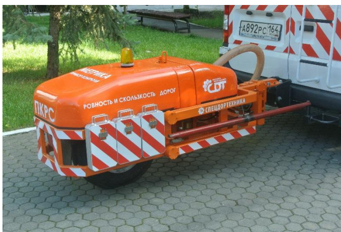
Установка ПКРС «Метрика»
