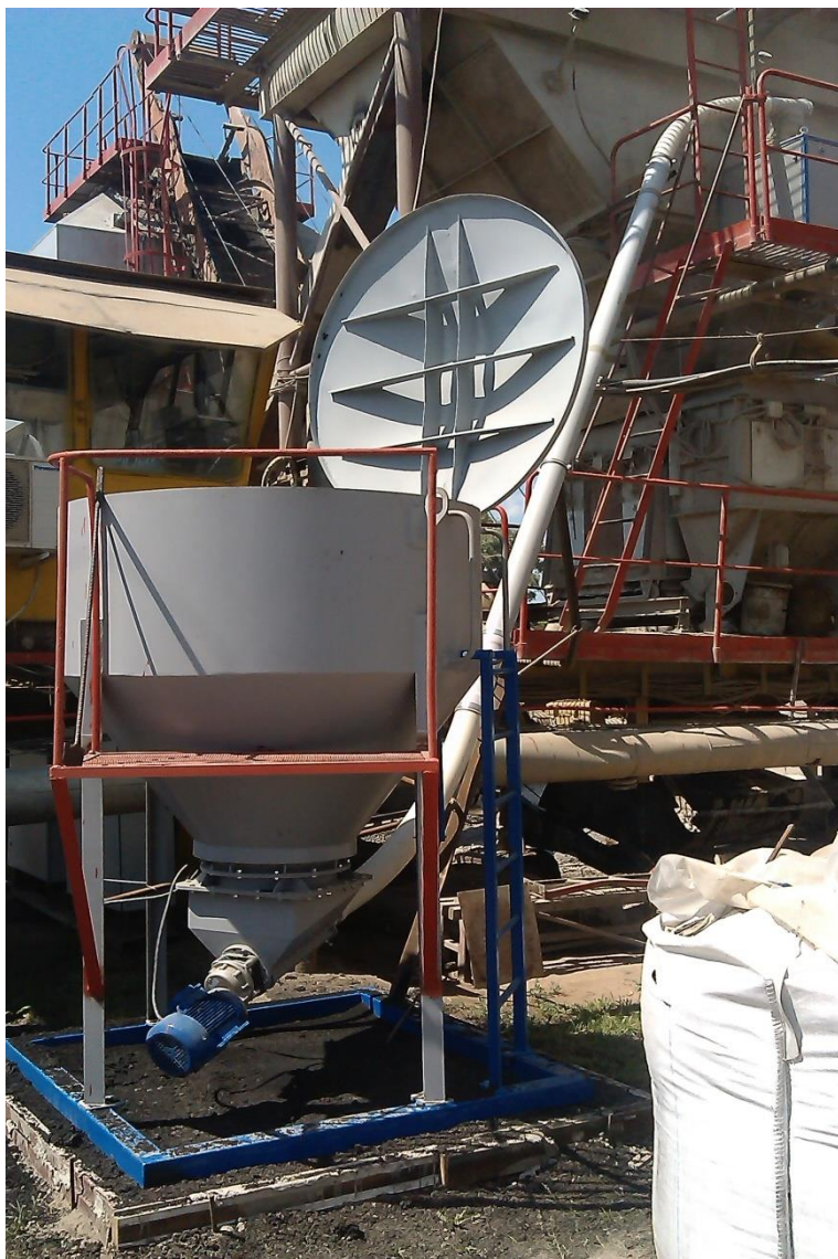
Рис. 4 – Подача РБВ-Г по стандартной линии подачи целлюлозы
