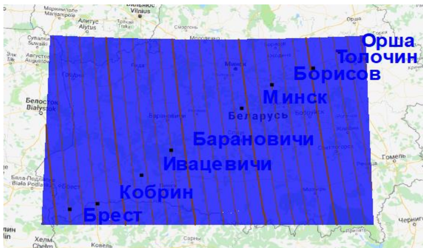
Рис. 3 – Поверхность, построенная по значениям масштабных искажений для СК-95
