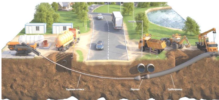
Рис. 1 – Метод управляемого прокола
