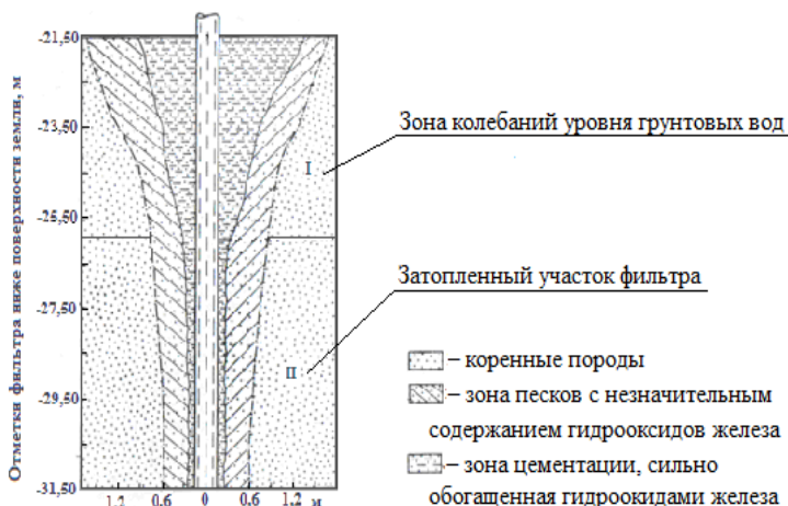
Рис. 1 – Зона измененной проницаемости вокруг фильтров водопонизительных скважин Волгоградской ГЭС [1]
