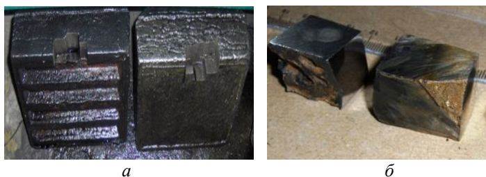
Рис. 2 – Образцы на износостойкость: а – наковальня дробилки модели KEV 96; б – образцы
