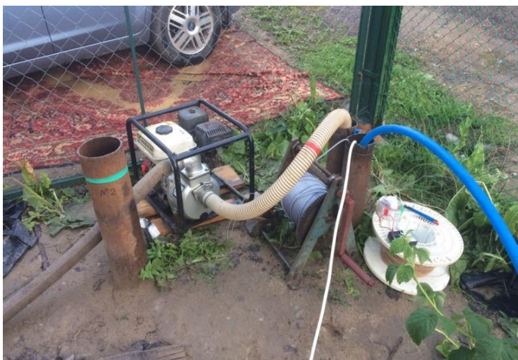
Рис. 3 – Полевые испытания скважины двухколонной конструкции (слева типовая скважина)
