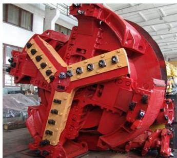
Рис. 1 – Расположение зубков на лучах центрального ротора КРП-3
