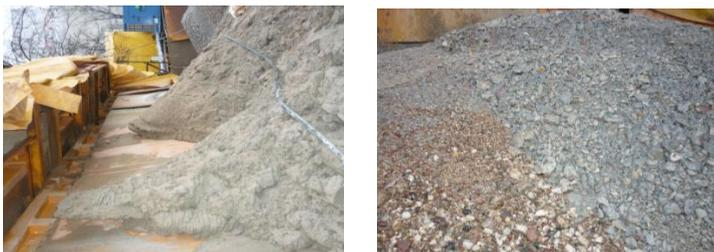
Рис. 1 – Фракции грунта после сепарационной установки
