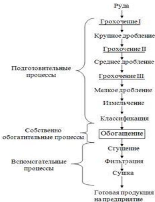
Рис. 2 – Процессы обогащения полезных ископаемых
