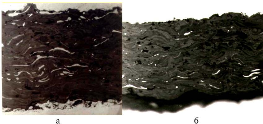
Рис. 2.16. Микроструктура плазменного покрытия из порошков  $\text{Al}_2\text{O}_3\text{-TiO}_2\text{-}12\%(\text{CaF}_2\text{-Ni})$ , полученных методом агломерирования мелкодисперсной шихты с последующим высокотемпературным спеканием ( $\times 500$ ):
