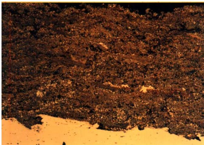
Рис. 4.8. Микроструктура покрытия из  $\text{ZrO}_2$ -ГА на образце из титана
