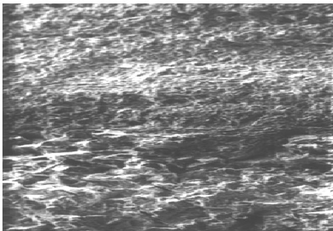
Рис. 4.14. Микроструктура покрытия из  $\text{TiO}_2$ -ГА на образце титана ( $\times 500$ )
