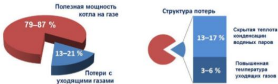
Рисунок 1 – Теоретический потенциал утилизации тепла дымовых газов котельных установок на природном газе
