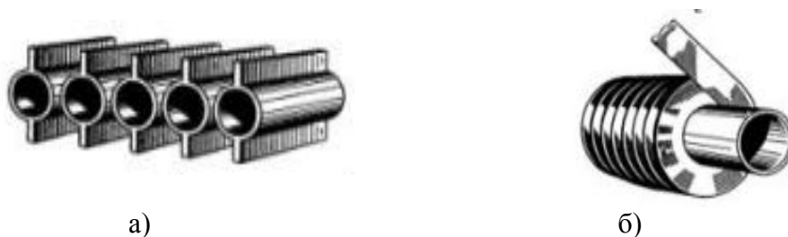
Рисунок 1 – Трубы с плавниковым (а) и поперечно-спиральным (б) оребрением
