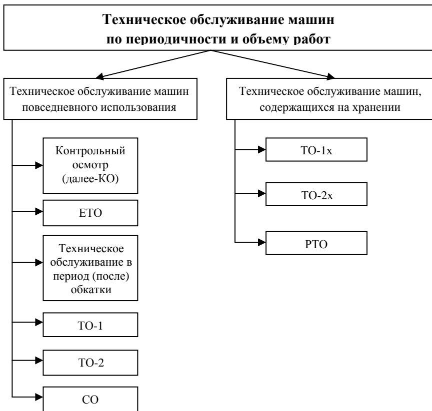
Рис. 3. Виды технического обслуживания для машин по периодичности и объему работ
