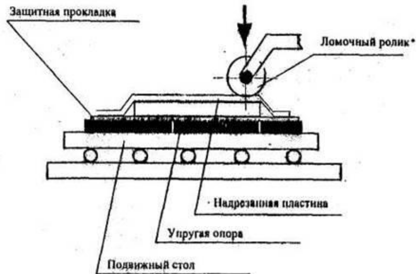
Рисунок 1.4 - Разламывание пластин валиком
