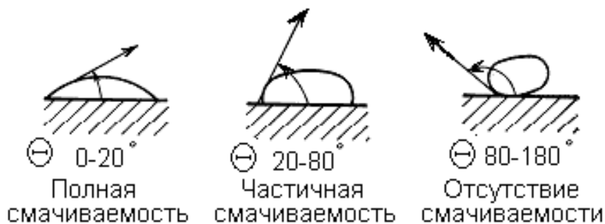
Рисунок 2.1- Определение смачиваемости по краевому углу смачивания
