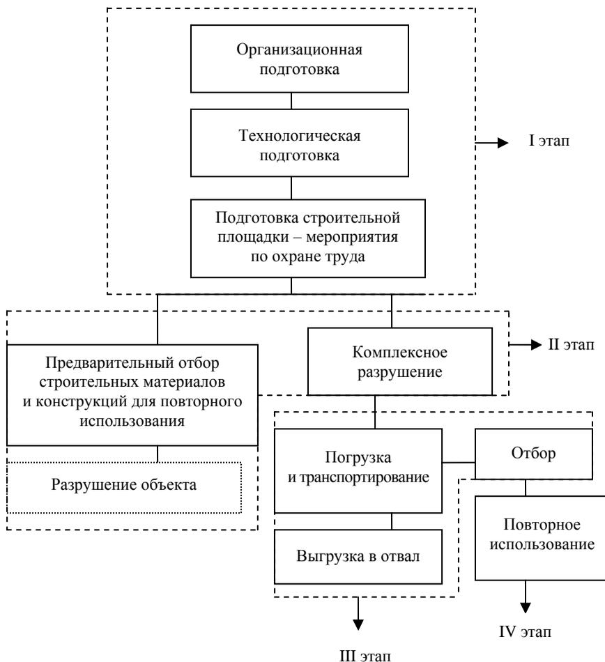
Рис. 5.1. Схема организации процессов разрушения конструкций:
