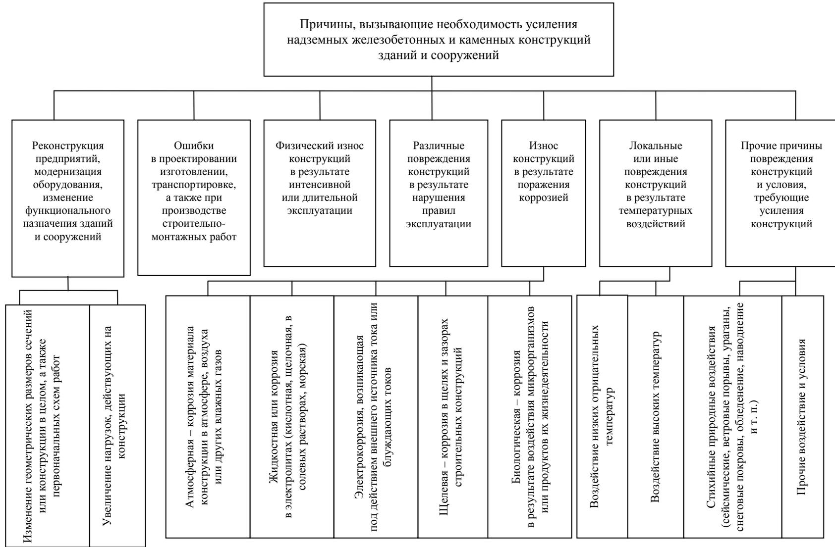
Рис. 6.1. Классификация причин, вызывающих необходимость усиления строительных конструкций
