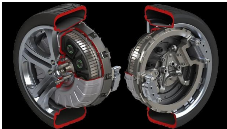
Рисунок 6 Система мотор-колесо современного гибридного автомобиля
