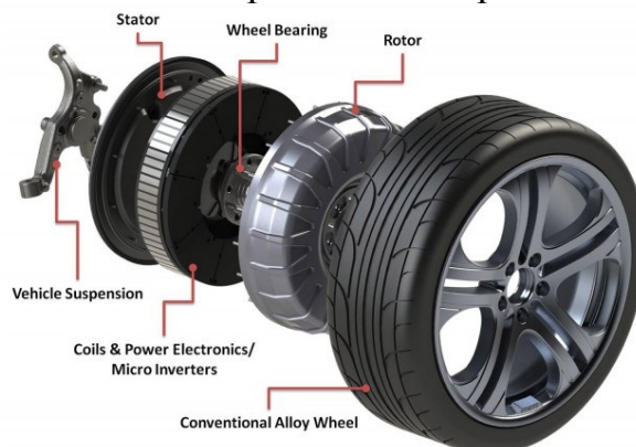
Рисунок 6 Система мотор-колесо современного электромобиля
