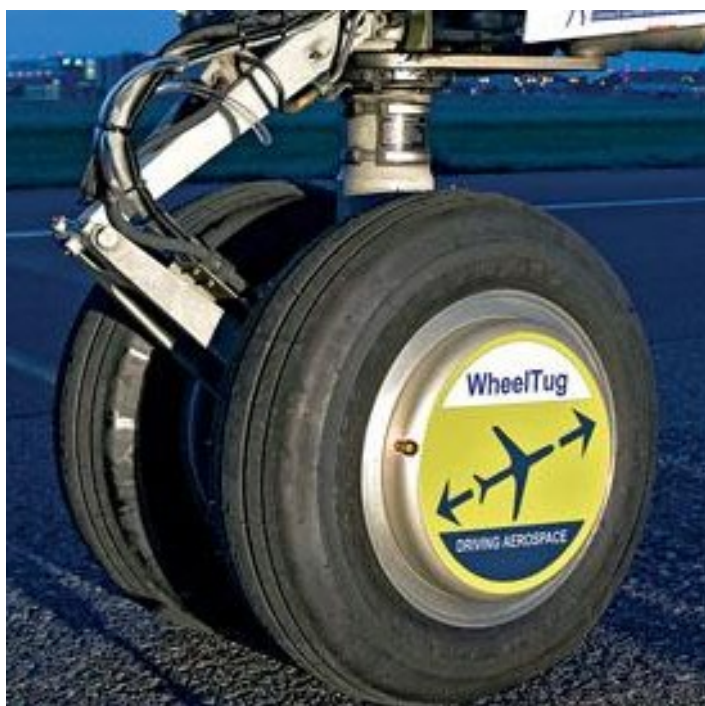
Рисунок 8 Мотор-колесо на транспортном самолете
