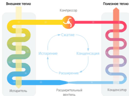
Рисунок 1.5.1 – Принцип работы теплового насоса
