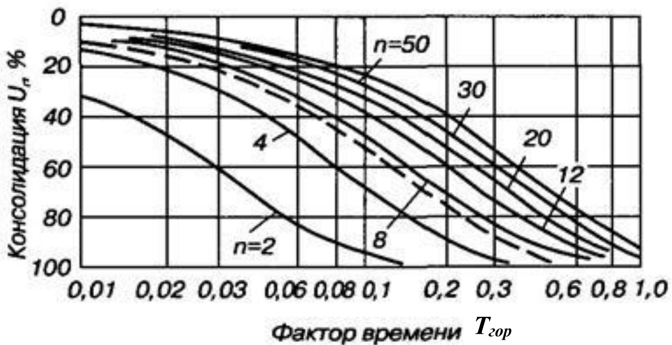
Рисунок 7.1 График для определения степени консолидации слоя водонасыщенного грунта с вертикальными дренами: а – при вертикальной фильтрации; б – при горизонтальной фильтрации.
