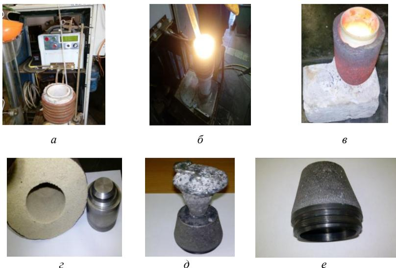
*a* – высокоскоростная плавильная установка; *б* – процесс плавки силицида; *в* – жидкий силицид перед разливкой; *г* – технологическая оснастка (литейная форма и токовод); *д* – отливка с прибыльной частью; *е* – образец катода-мишени
