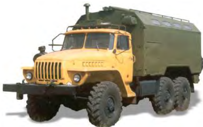
Рис. 3.4. Мастерская ремонта электрооборудования МРЭ-АМ1
