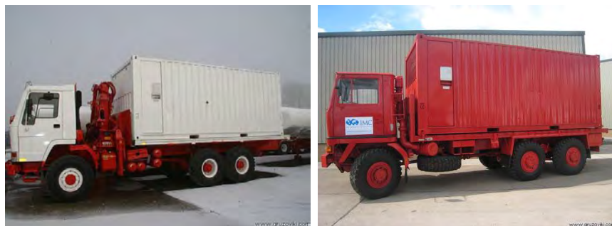
Рис. 3.31. Передвижная авторемонтная мастерская на шасси IVECO BEDFORD MERCEDES-BENZ MAN с КМУ (слева) и без него (справа)
