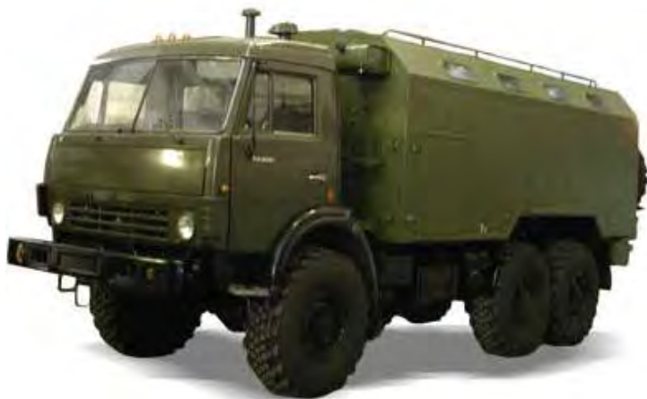
Рис. 3.7. Мастерская заряда и ремонта аккумуляторов МЗА
