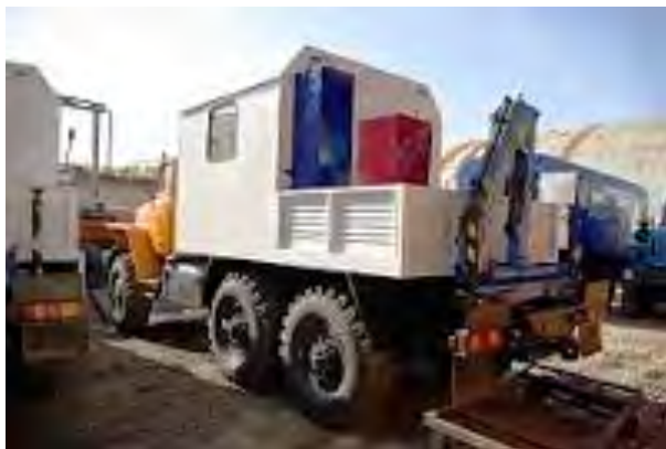
Рис. 3.15. Передвижная мастерская АРОК-489501 (фургон, грузовая платформа, КМУ) на шасси Урал-4320(3)-1112-41
