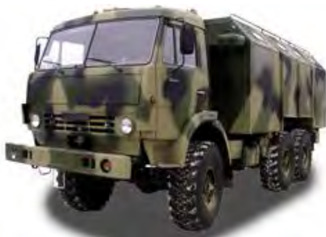
Рис. 3.5. Мастерская ремонта электрооборудования МРЭ-А
