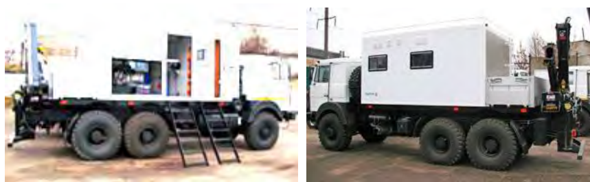
Рис. 3.38. Передвижная аварийно-ремонтная мастерская с крановым манипулятором на базе шасси МАЗ 631705-370
