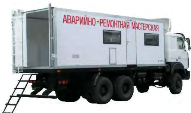
Рис. 3.40. Спецавтомобиль на базе шасси МАЗ-631705-261 с кузовом 673140
