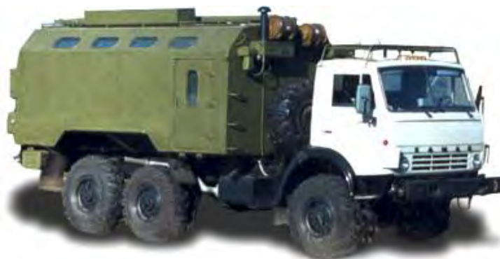
Рис. 3.2. Мастерская ремонтно-слесарная МРС-АМР
