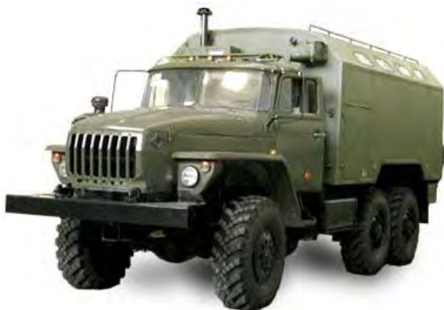
Рис. 3.8. Мастерская сварочных работ МСР
