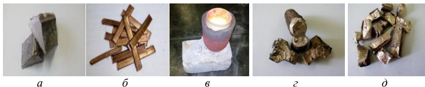
а – металлический магний; б – лом меди; в – плавильный тигель с расплавом; г – быстроохлажденная отливка лигатуры; д – лигатура измельченная Рисунок 1 – Этапы процесса получения «тяжелой» магниесодержащей лигатуры
